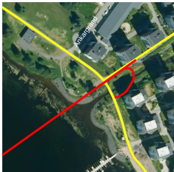
Figur 5-10 Utformningsförslag på broanslutningen för bron mot Umeå Östra (nr.3 i Figur 5-5). Gult stråk: befintlig gång- och cykelinfrastruktur. Rött stråk: bro som löper över den befintliga gång- och cykelbanan med anslutande länkar.
