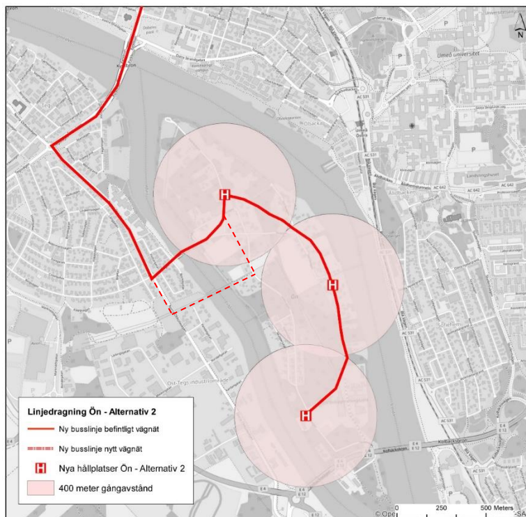
Figur 6-8 Alternativ 2: linjesträckning med principiella hållplatslägen på Ön. Streckad linje visar lösning där den nya bron även används för busstrafik.
