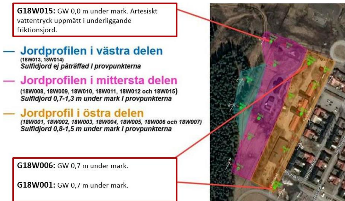
Figur 6. Översiktlig sammanställning av geoteknisk information från de 15 provpunkter som togs i den geotekniska utredningen för Gitarren.
